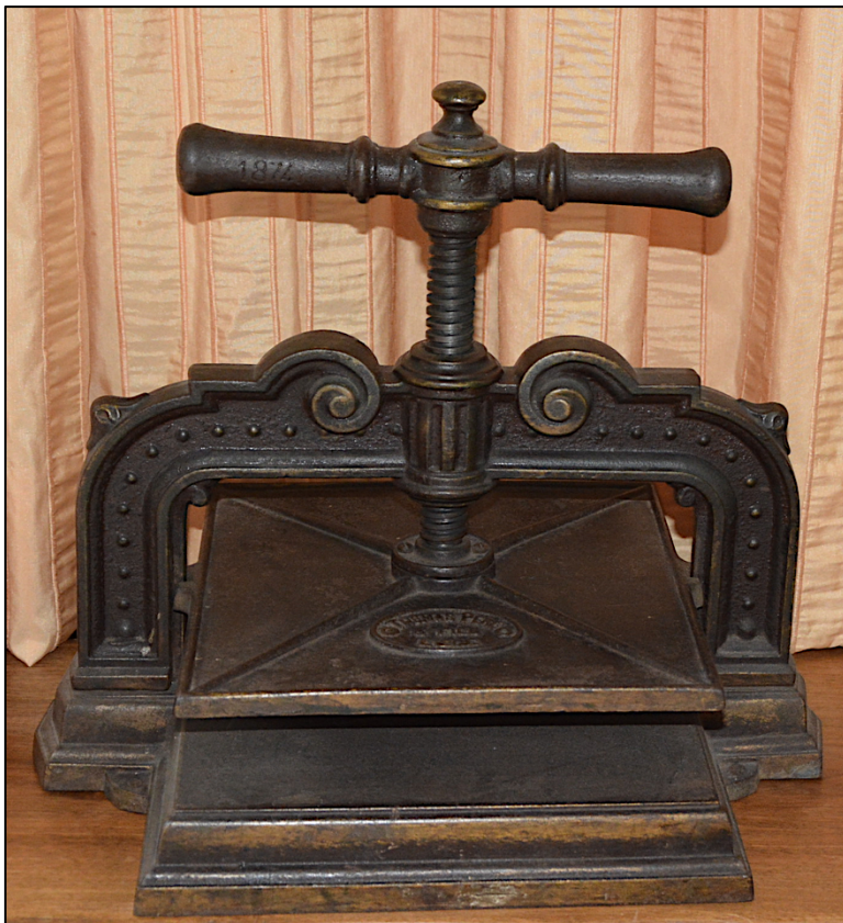
Presse à copier ou presse de notaire 7 . Inventée par James Watt (1736-1819), la presse à copier fut surtout utilisée fin du XIX e /début du XX e siècle.
